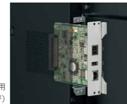
背面の拡張スロットに差し込んで使用 (写真はPN-ZB03H取り付けイメージ)
