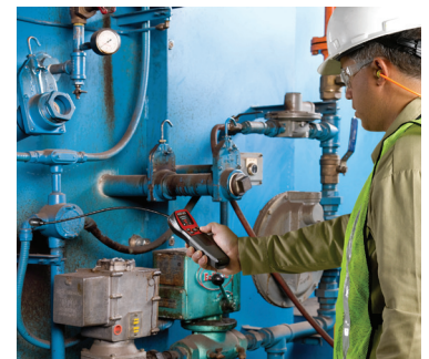
プラント/ビルの保守時にmicro CD-100を使用してガスを探知
