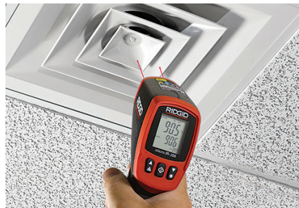
フローシステムで放熱効率を測定し、熱損失の有無や位置を特定します。
